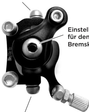
Untere Klemmschraube für den Bremssattel
